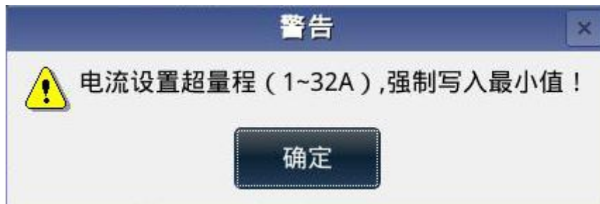
图 4-20 电流设定超量程警告
