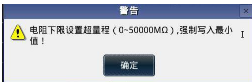
图 4-17 电阻下限设置超量程提示
