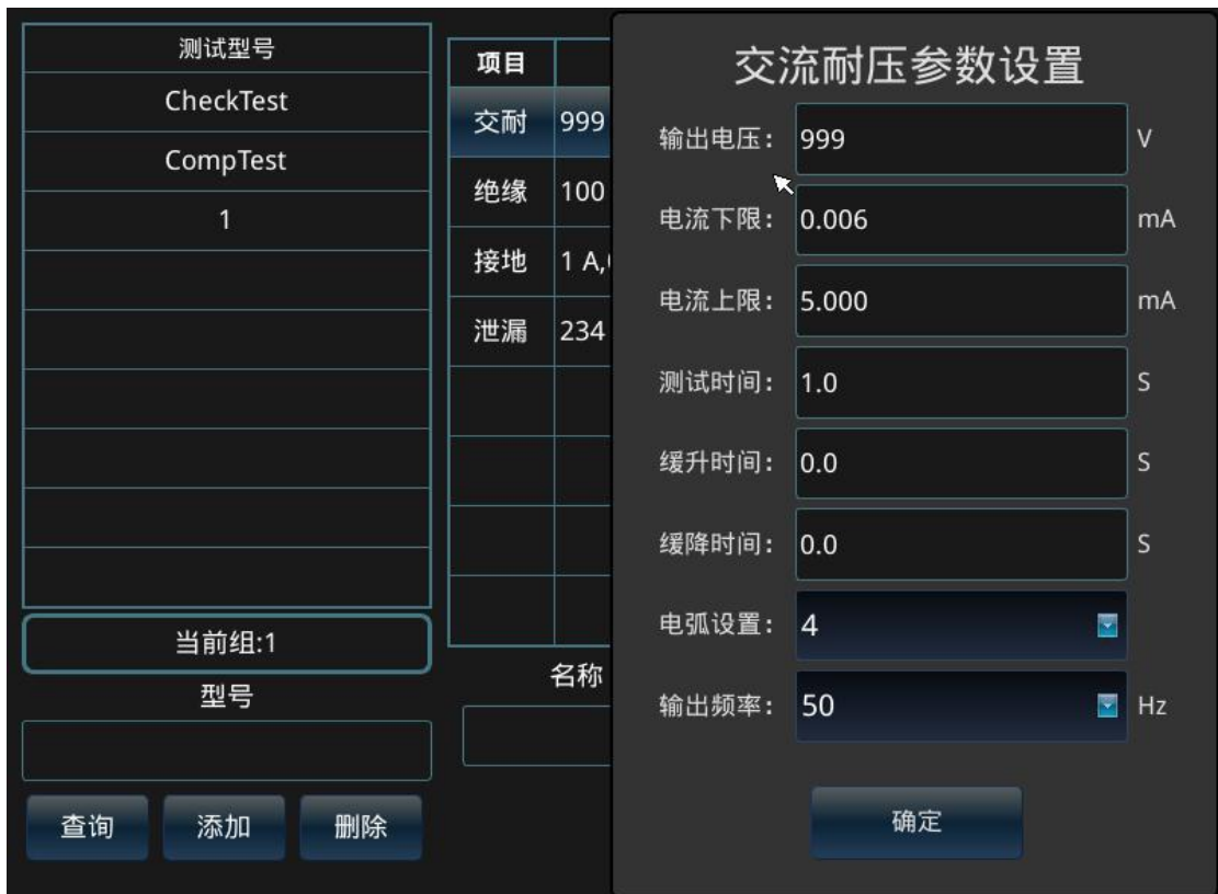
图 4-15 交流耐压参数设置界面
