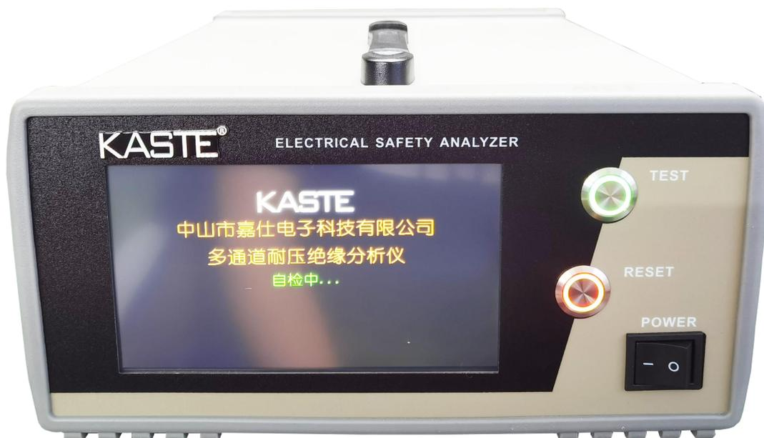
KS1920/KS1930 是我公司开发的多通道交直流耐压绝缘测试仪。
